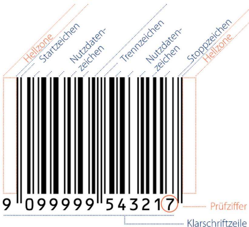
Abbildung 1.1: Bestandteile eines EAN
